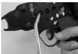
3. Reinigen Sie die mechanischen Teile der Rundverschlusszange mithilfe eines Drucklufthammers.
