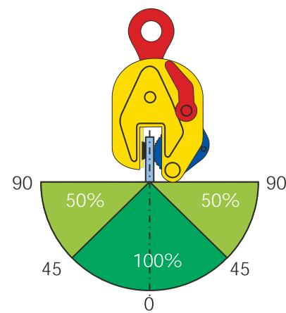
KORREKT BRUK AV PLATELYPER FOR VERTIKALE LØFT
