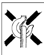
Fig. 3 c Krokspærren blokkert!
