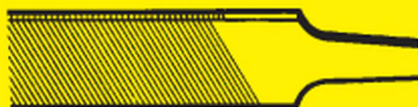
**Engradiga filar.** För filning i stål och metaller med normalt arbetstryck.
