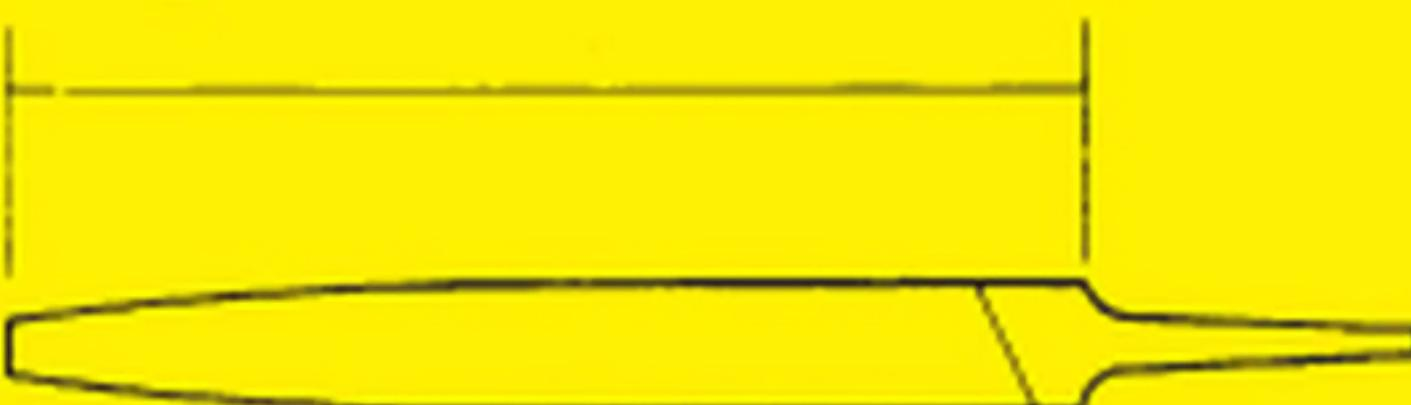
Den angivna längden på filar mäts utan tänge. Längden på filar bör väljas efter arbetssstycket: ju större arbetssstycke dess längre fil. För att erhålla större stabilitet bör hellre en för lång, än en för kort fil väljas.
