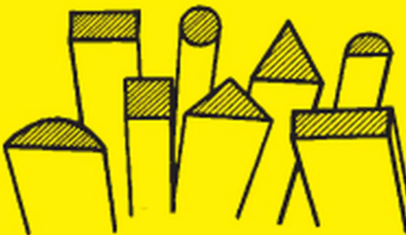
Filarna har olika tvärsnitt för att passa till olika former på arbetssstycken.
