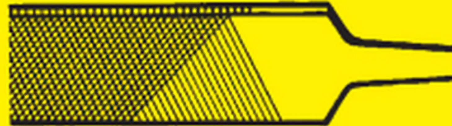
**Dubbelgradiga filar.** Består av två diagonala huggningar. Användes med högre arbetstryck än engradiga. För järn, stål och metaller men även för plaster och trä etc.
