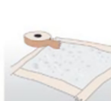
1. Mät underlagets fuktighet.
