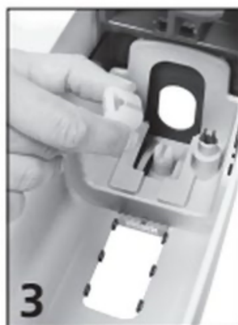
Ta bort plastdetaljen. Om den är hal, använd tång eller skruvmejsel.
