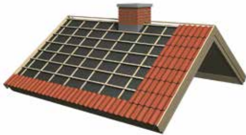
Bild 10. Lägg först en nedre rad från höger till vänster. Forsätt sedan med en rad ända upp tillnocken. Se till att den ligger i vinkel mot nedersta pannraden. Fortsätt med två - tre rader i taget ända upp. Kontrollera att raderna ligger rakt.
